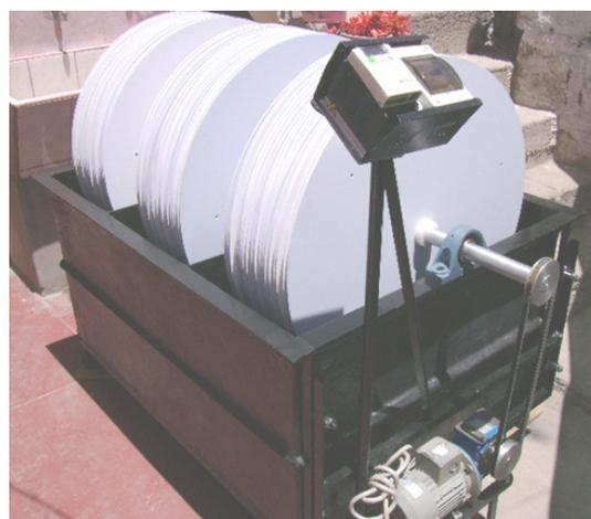
**Fig. 1. Biorreactor CBR, listo para su activación y funcionamiento.**
